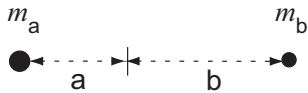
Abbildung 42: System von zwei starr verbundenen Massen als Modell für das 2-atomige Molekül.
