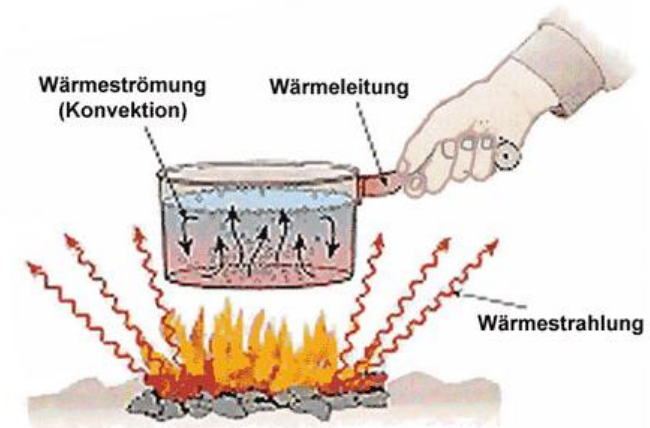
Die 3 Wärmearten: Wärmeströmung, Wärmeleitung, Wärmestrahlung
