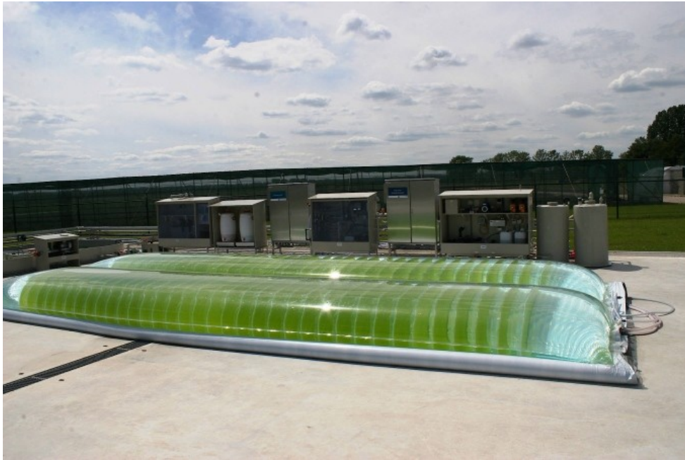
Können künftig mit Algenfarmen wie hier in einer Pilotanlage in Wageningen nennenswerte Mengen Kohlendioxid in wertvolle Produkte umgewandelt werden? Bild: Universität Wageningen
